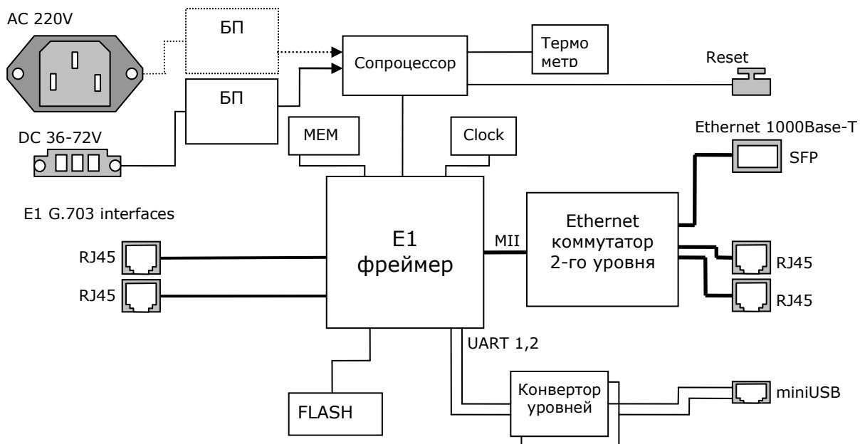
Основные узлы мультиплексора-коммутатора Sprinter TX.
