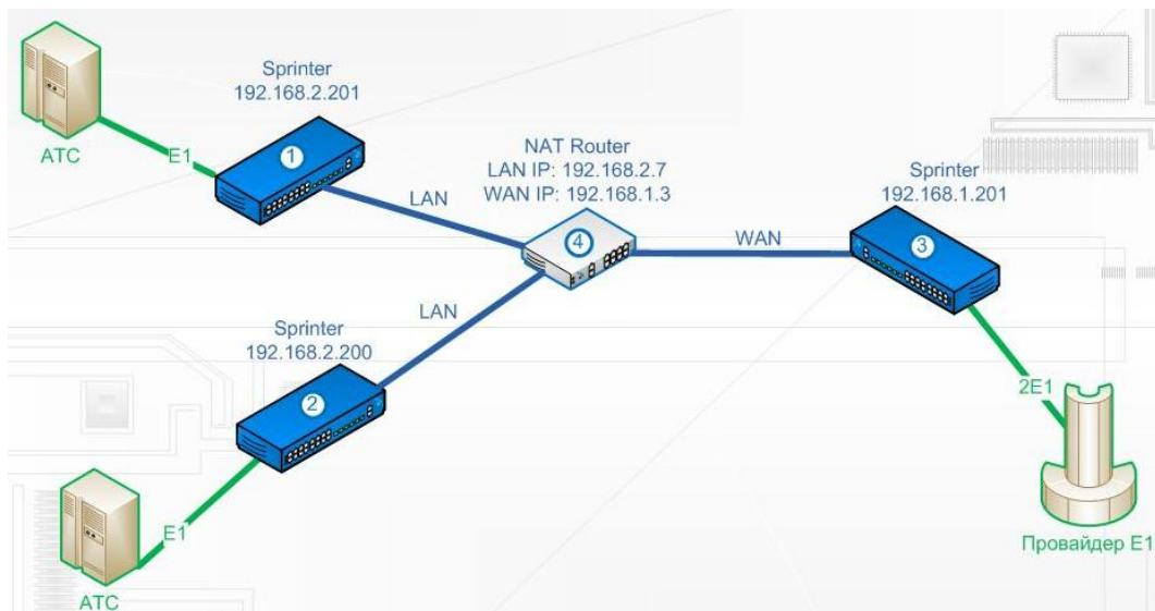
Мультиплексоры-коммутаторы Sprinter TX необходимо настроить следующим образом
